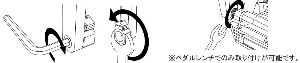
※付属のワッシャー 大（厚み 0.3mm, 0.6mm）を取り付けることで、ペダル装着用部品の固定角度の調節が可能です。
