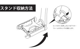
アウターフレームを収納します。アウターフレームをペダル内部へ折りたたみ、ロック ボタンを押しながら収納します。ロックボタンと連動する**ボルトをアウターフレームの** ボルト穴に差し込み固定します。
