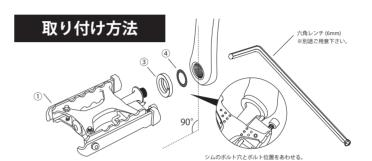
左ペダルとクランクの間にシムとワッシャーを上図の順列で取り付けます。シムのボル ト穴とロックボタン左のボルトの位置をあわせます。各ペダルの固定には回転方向の指 定があり、**左ペダル ( スタンド側 ) は反時計回り、右ペダルは時計回り**に取り付けます。 左ペダルの取付はクランクの角度は**必ず地面と垂直、ペダルは地面と平行**にしてくださ い。ペダルを仮止めした後、クランク背面から六角レンチを用いて固定します。右ペダ ルの取付はワッシャーとシムは不要です。
