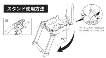
左クランクを地面と垂直の位置に設定します。ペダルスタンドのロックボタンを押し、 アウターフレームを展開します。ロックボタンを開放する時、ボタンと連動する**ボルト** をシムのボルト穴に差し込み固定します。次に自転車が動かないように、付属のブレーキレバー固定ストラップをブレーキレバーに取り付け固定します(図1)。
