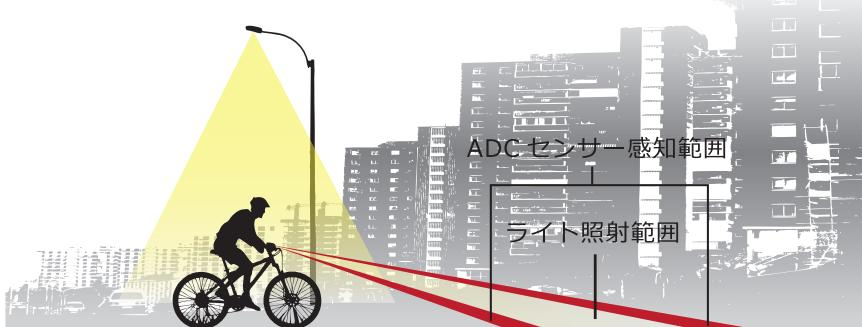
走行中 ADC センサーによりライト本体より前方の照度を感じし、ライトの明るさを自動調整します。
