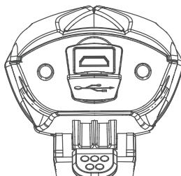
1. ライト本体のUSB端子カバーを開け、充電ポートに付属のUSBケーブル（ライト本体取り付け側）を差し込んでください。
