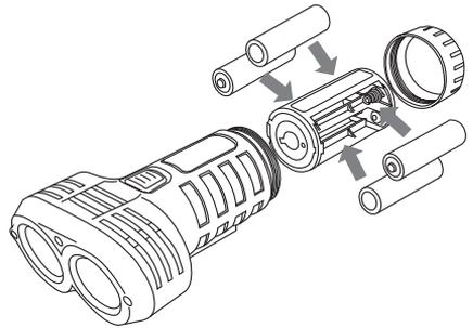
※電池は電極の方向を確認し、必ず指定方向に挿入してください。
