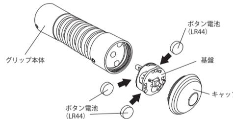
LED グリップ端のキャップを反時計回りに回し取り外します。内部から基盤を取り出し、ボタン電池 (LR44 × 3 個) を取り外します。ボタン電池を新品に交換した後、基盤をグリップ先端に戻し、キャップを時計回りに回し固定します。
