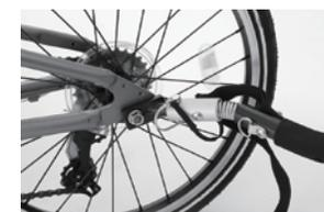
2. ジョイントバー先端のアタッチメントをハブ軸にはさみ、ボルトを締めます。
