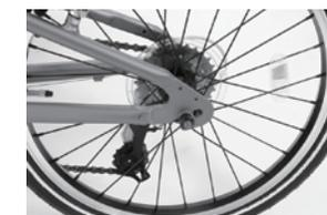
1. 自転車後輪、進行方向向かって左側のハブボルトを外します。
