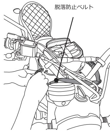
2. バッグ側面の脱落防止ベルトをハンドル回りに取り回し、操舵に影響しないようにベルトの長さを調整します。
