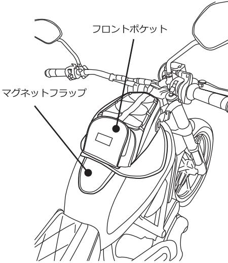
1. フロントポケットを手前にしてバイクのタンクの上に設置し、4箇所のマグネットフラップで固定します。
