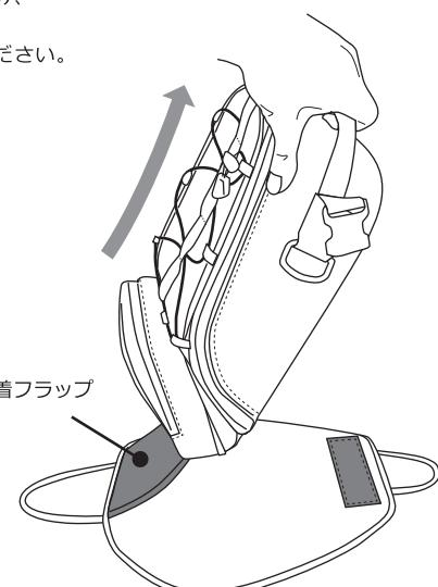
2. そのままバッグ本体を持ち上げ、マグネットベースの装着フラップをバッグ背面の装着スリットから抜きます。
