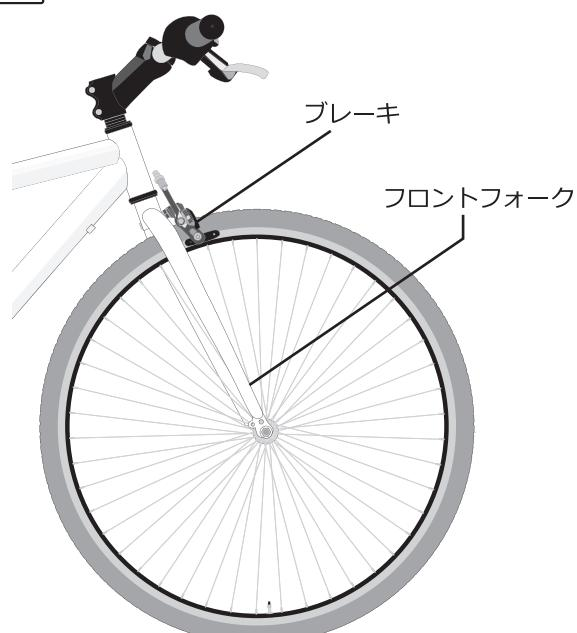
フロントフォークは、ブレーキがフロントフォークの前方（ディスクブレーキ採用車は左側）に位置する向きに合わせてください。フロントフォークの向きを間違えたまま走行すると、ペダルとタイヤが干渉し事故を起こす危険があります。乗車前に必ずフロントフォークの向きを確認し、正しい向きに設定してください。
