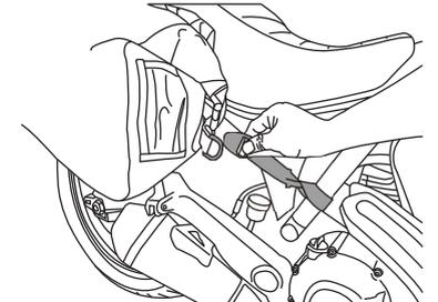
**3** 左右サイドバッグの②固定用ベルト用Dリングに④後方固定用ベルトを接続し、バッグを固定します。
