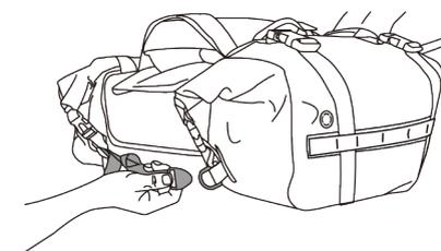
サイドバッグはマフラーに接触しない位置に間隔（10cm目安）を保った状態、また排気があたらないように取り付けてください。
