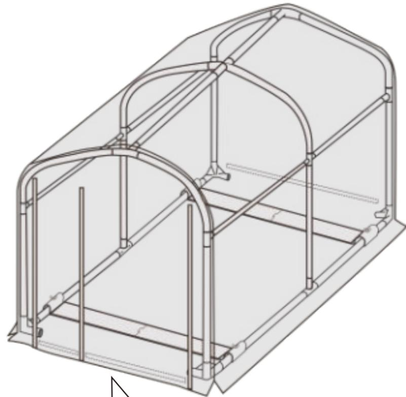
前後の入り口部分に⑱PEボードを取り付けます。入り口下部の点線部分にあるスリットに⑱PEボードを奥まで差し込んでください。
