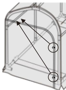
スクリーンフックは、スクリーン開放時にガレージ内のパイプに引っ掛けて使用してください。
