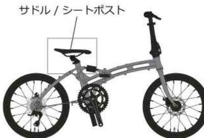
シートポストを操作し、サドルの高さを調整します。
