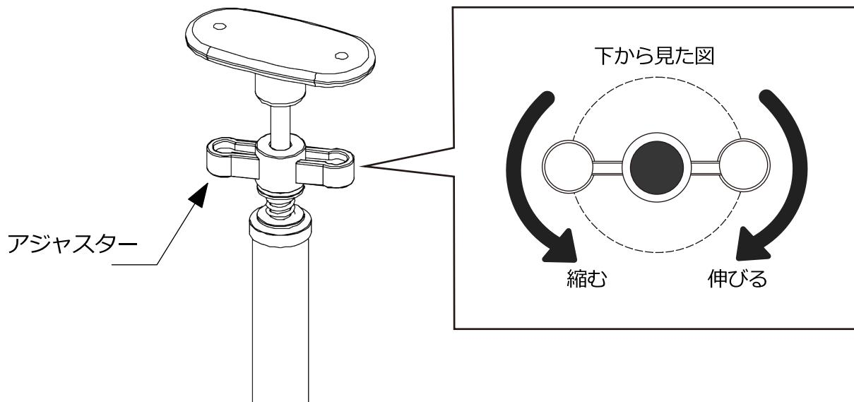
**4 しっかりと天井に固定されていることが確認できたら、付属の⑬ネジを用いて、固定用ポールの先端部と天井の接地面を固定してください。**
