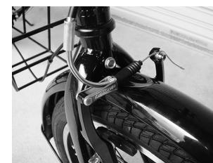
組み立て工程1にて開放していたV型ブレーキを接続します。V型ブレーキのブレーキアーチを中央に寄せながら、ブレーキケーブルをストッパーに引っ掛けます。
