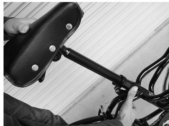
シートポストをフレームに取り付け、サドルの高さを調整します。
