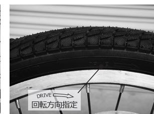
フロントホイールをフロントフォークに取り付けます。フロントホイールのタイヤ側面にある回転方向の指定に従い、矢印の方向を自転車前方に設定し、フロントフォークに取り付けます。
