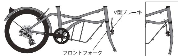
このとき、フロントフォークに取り付けられているV型ブレーキが自転車前方に向くようにフロントフォークを回転させてください。
