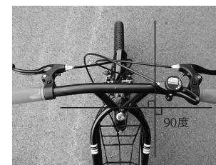
付属の工具を用いてハンドルシステムを確実に固定します。このとき、フロントホイールとハンドルバーが90度になるように設定します。
