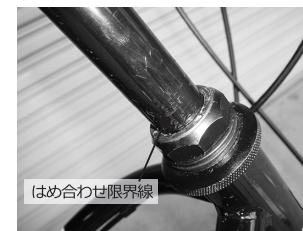
ハンドルシステムを取り付けます。ハンドルシステム先端を左図のようにフレームに差し込みます。このとき、ハンドルシステムに刻印されている**はめ合わせ限界線**が見えない位置で高さを設定します。
