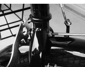
フロントホイールを固定します。工具を用いてハブボルトを左右交互に締め上げていきます。同時に、仮止めをしていたマッドガードのボルトも増し締めを行い、確実に固定を行います。
