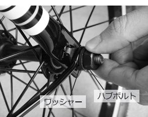
マッドガードの固定ステーをハブ軸に取り付けます。フロントホイールから取り外したワッシャー、ハブボルトを、左図に従い固定ステーの上から取り付けます。
