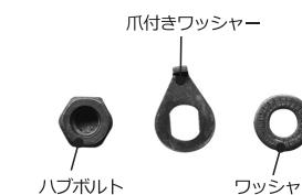
次に、フロントホイールのハブ軸からハブボルト、ワッシャー、爪付きワッシャーを取り外します。
