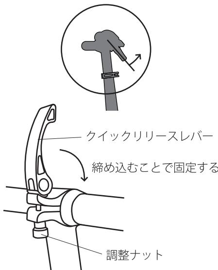
ハンドルシステム上部にあるクイックリリースレバーを開放し、ハンドルの角度を調整します。ハンドルをお好みの角度に設定し、クイックリリースレバーで確実に固定します。
