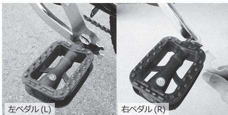
ペダルを取り付けます。ペダルには右側用（Rの刻印、ペダル軸に溝なし）と左側用（Lの刻印、ペダル軸に溝あり）があります。取り付け前にペダルの左右に間違いがないか確認してください。
