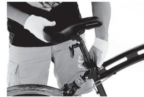
サドルをお好みの高さに設定し、クイックリリースレバーで確実に固定します。このとき、サドルの高さはシートポストに刻印されている**はめ合わせ限界線が見えない位置**に設定してください。
