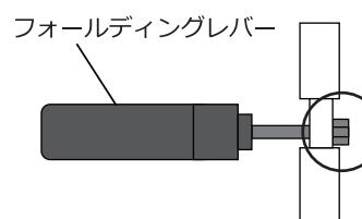
フォールディングレバーの固さは、別途工具を用いて調整することができます。左図の丸印部分にあるフォールディングレバーの末端のナットで固定力を調整してください。
