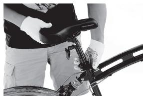
フレームに取り付けられたシートポスト、サドルの高さを調整します。
