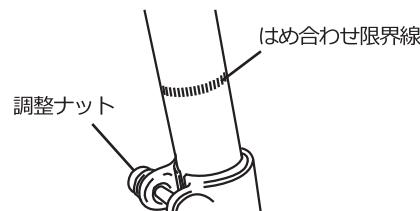
また、固定力が弱いと感じた場合は、クイックリリースレバーをゆるめた状態で反対側にある調整ナットを回して固定力を調整してください。
