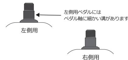
ペダルを取り付けます。ペダルには右側用（Rの刻印、ペダル軸に溝なし）と左側用（Lの刻印、ペダル軸に溝あり）があります。取り付け前にペダルの左右に間違いがないか確認してください。
