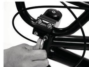
クランプの固定は、各ボルトに均一なトルクがかかるよう、左図の順に少しずつ締め上げ、確実に固定します。
