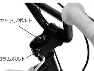
ハンドルと前輪が垂直になるよう設定します。アヘッドのコラム側の上下2本のボルトを均一のトルクで固定し、キャップボルトを固定します。
