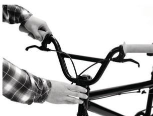
アヘッドからクランプを取り外し、ハンドルバーを取り付けます。この時、ハンドルから出るワイヤ類にもつれがないか必ず確認してください。
