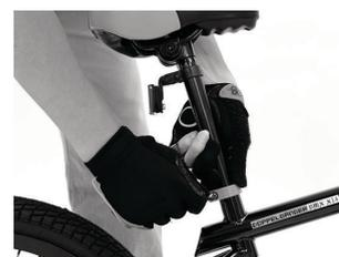
サドルを取り付けます。サドルの支柱をフレームに差し込みます。サドルの支柱に刻印されるはめ合わせ限界線が見えない範囲で高さを設定し、ボルトで固定します。
