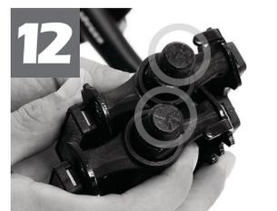
ペダルを取り付けます。ペダル軸先端に(R)と刻印されたペダルは右クランクに**時計回り**で取り付け、(L)と刻印されたペダルは左クランクに**反時計回り**で取り付けます。ペダルは手締で取り付けした後、最後に付属の板レンチで確実に固定します。
