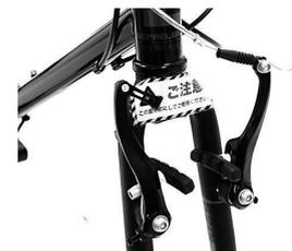
ブレーキアーチを中央に寄せながら、ブレーキケーブルを引き上げ、ブレーキを開放します。
