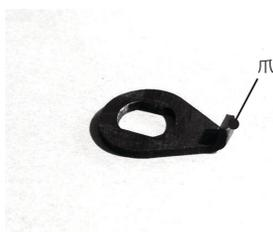
前輪の左右ハブ軸に爪付きワッシャーを取り付けます。爪をフォーク側に向け、前輪取り付け穴の上部に設けられた小さな穴に引っ掛けます。
