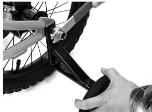
自転車に乗車時、補助輪と地面は1cmのすきまがあくように調整した後、ハブボルトで固定します。
