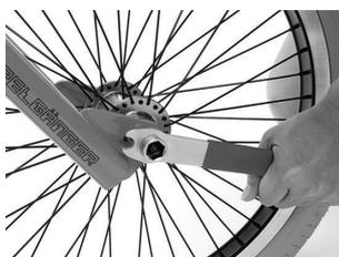
ハブボルトを取り付けます。工具を用い、ハブボルトを**左右交互**に締め上げ確実に固定します。
