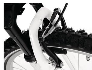
作業行程1で開放した前輪ブレーキを接続します。左右ブレーキアーチを中央に寄せながらブレーキケーブルをストッパーに引っ掛けます。
