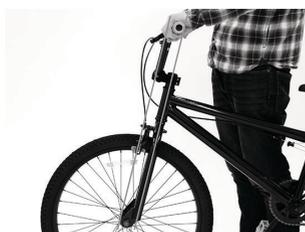
クランプを被せハンドルを仮止めで固定します。ハンドルとフォークが平行となるよう、ハンドルの角度を設定します。
