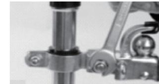
2. ヒッチメンバーにヒッチボールマウントを取り付けます。
