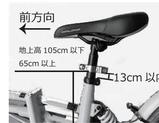
1. シートポストを一旦抜き、シートポスト下側よりヒッチメンバーを設置します。シートポストの直径に合わせて適切なシムを使用してください。トウバーが概ね水平になる位置で、ネジを締めて固定してください。
