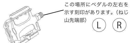
**5** ペダルを取り付けます。ペダルには左右の区別があります。まずはペダルの左右を確認してください。ペダル左右は、右の画像に示す位置に記されています。（右足側=R、左足側=L、を示す刻印があります）※車種によっては、すでにペダルが取り付けられている場合があります。
