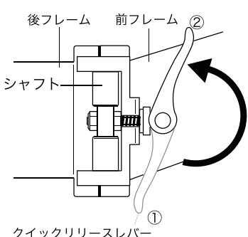
**2** 前フレームと後フレームを開き、ロックします。フレームを（乗車する状態となるよう）開き、前フレームと後フレームが正しく結合されると、シャフトが自動的に下がり前フレームと後フレームとを結合します。フレームをロックしたらスタンドを立て、自転車が倒れないように安定させてください。
