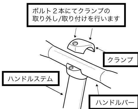
**3-1** ハンドルバーをハンドルシステムへ取り付けます。付属の六角レンチを使用してクランプを固定するボルトを緩め、ハンドルシステム上部または前部のクランプを取り外した後にハンドルバーを挟み、クランプをもとの状態へと固定します。
