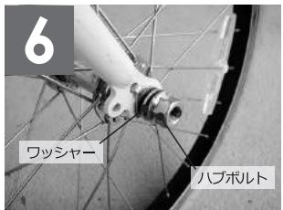
ワッシャー、ハブボルトを取り付けます。付属の板レンチを用い、ハブボルトを左右交互に締め上げ固定します。
