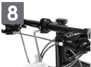
作業工程7で取り外したクランプを被せ、ハンドルを固定します。固定ボルトはクランプとアヘッドの間隔が均一となるよう上下交互に締め上げ固定します。
