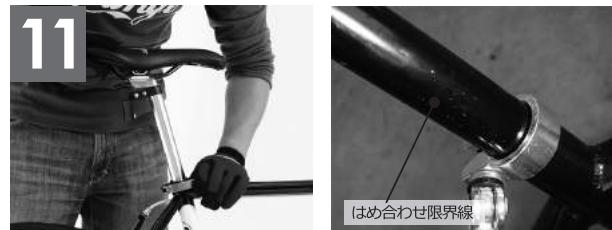
サドルを取り付けます。サドルの支柱をフレームに差し込みます。サドルの支柱に刻印されるのはめ合わせ限界線が見えない範囲で高さを設定し、クイックリリースで固定します。
