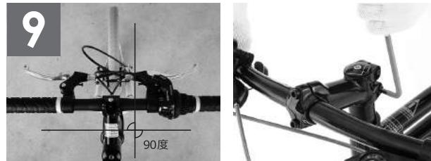
ハンドルと前輪が真っ直ぐになるよう設定し、アヘッドシステム固定ボルトを上下交互に締め上げ固定します。
