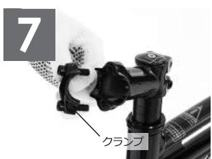
アヘッドステムからクランプを付属の工具で取り外します。ハンドルのワイヤー類(ブレーキ、シフター)に絡まりがないか確認し、ハンドルを中央位置に設定します。
