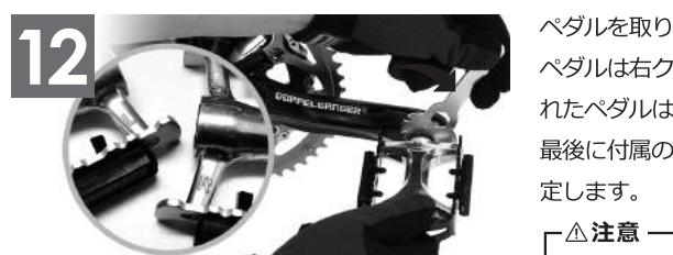
ペダルを取り付けます。ペダル裏面にRと記載されたペダルは右クランクに時計回りで取り付け、Lと記載されたペダルは左クランクに反時計回りで取り付けます。最後に付属の板レンチ、または六角レンチで確実に固定します。
