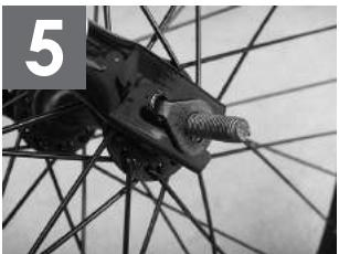
前輪をフロントフォークに取り付けます。タイヤは回転方向に指定があります。タイヤのトレッドパターン(タイヤの溝)を参考に、中央の溝が内側へ細く向かう方向を前方に設定します。
