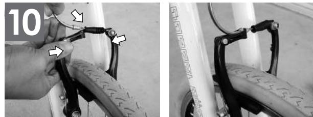
作業行程3で開放した前輪ブレーキを接続します。左右ブレーキアーチを中央に寄せながら、ブレーキケーブルをストッパーに引っ掛けます。
