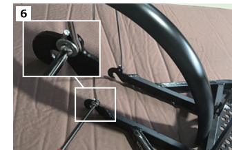
6 マッドガードのステー先端(フック部)を、付属のネジとワッシャーで、デッキ(フック型車軸受け部)に固定すれば、マッドガードの設置は完了です。
