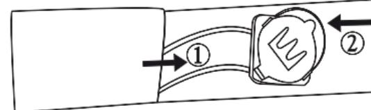
ON/OFF スイッチの裏面にある、バッテリーパックを取り出し、CR2032 電池 + 面を上にして交換してください。
